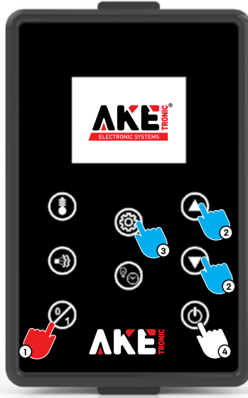
Şekil 7: Nem ve Sıcaklık Sensörü Ayarı
